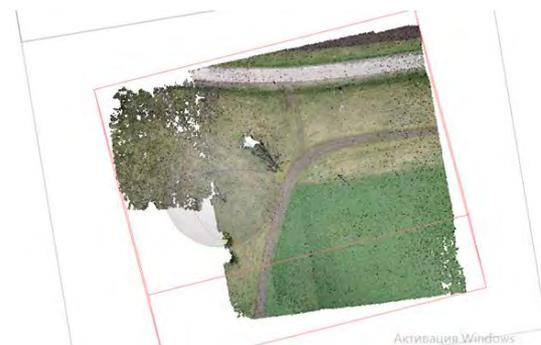
Рис. 3. Создание плотного облака точек
